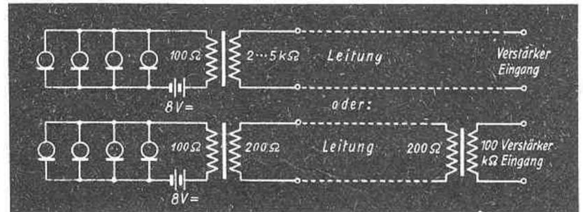
Abb. 3. Kohlemikrofon — Eingangsschaltung
