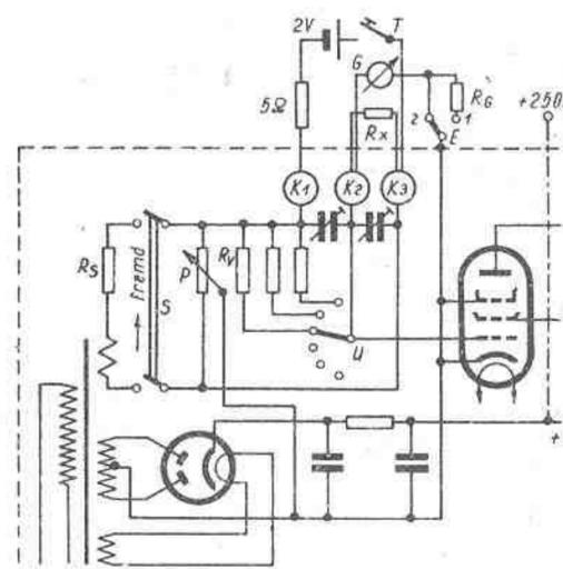
Nach beifolgender Skizze ist jedoch auch diese Möglichkeit gegeben, wenn man das Gerät von außen durch eine 2-Volt-Batterie speist. Der Netzstecker bleibt hierbei natürlich spannungsfrei.
