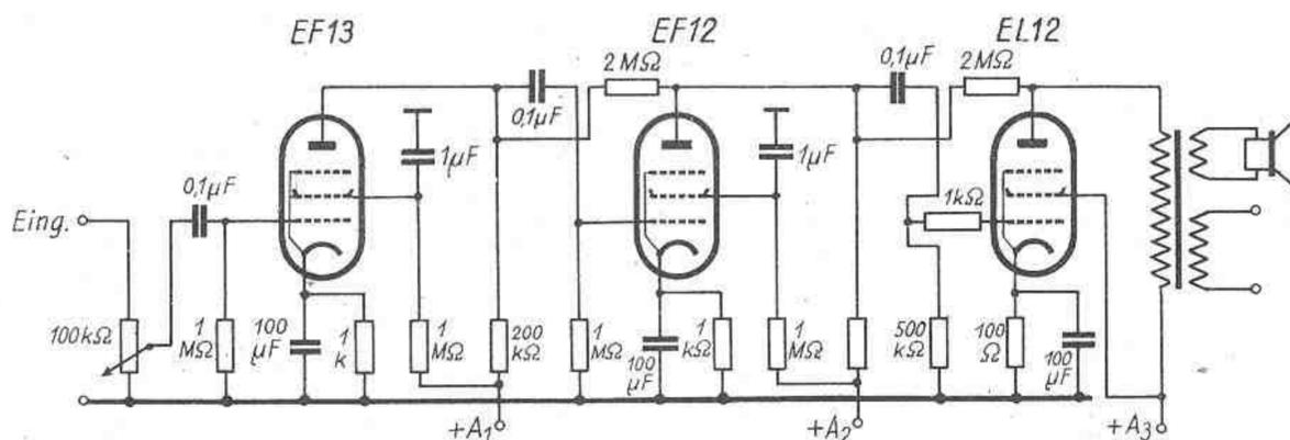
Abb. 1. Dreiröhren-Mikrofonverstärker
