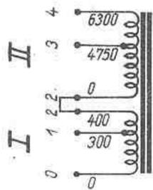
Daten: Es wurde ein Eisenpaket M 42 aus Dynamoblech IV ohne Luftspalt benutzt. Blechstärke 0,35 mm. Paketdicke 15 mm. Die Wicklung I bestand aus CuL-Draht 0,45 mm  $\phi$ , Wicklung II aus CuL-Draht 0,08 mm  $\phi$ .
