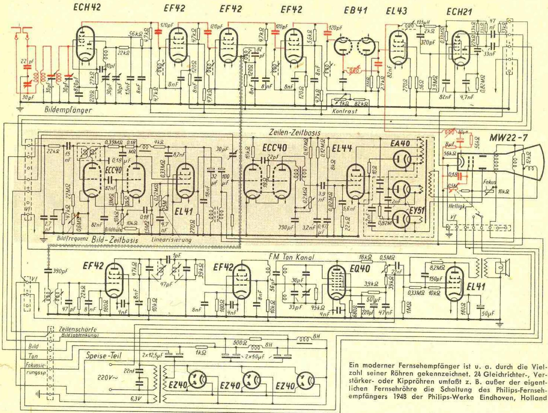
Ein moderner Fernsehempfänger ist u. a. durch die Vielzahl seiner Röhren gekennzeichnet. 24 Gleichrichter-, Verstärker- oder Kippöhren umfaßt z. B. außer der eigentlichen Fernsehöhre die Schaltung des Philips-Fernsehempfängers 1948 der Philips-Werke Eindhoven, Holland
