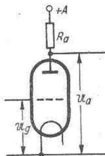
Abb. 3. Prinzipschaltung einer Elektronenröhre mit Anodenwiderstand  $R_a$
