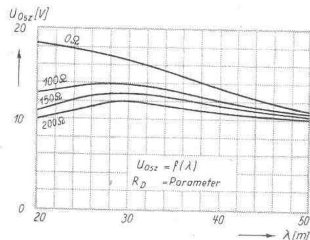
Abb. 7. Schwingspannung als Funktion der Wellenlänge
