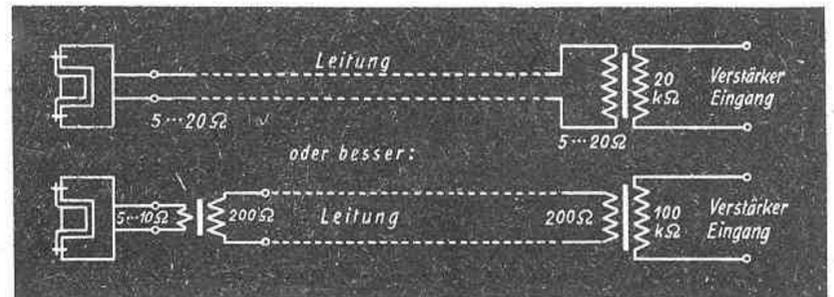
Abb. 4. Tauchspulenmikrofon — Eingangsschaltung
