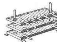
Streifenwiderstand mit durchbrochenem Träger aus Stealit oder Frequenta
