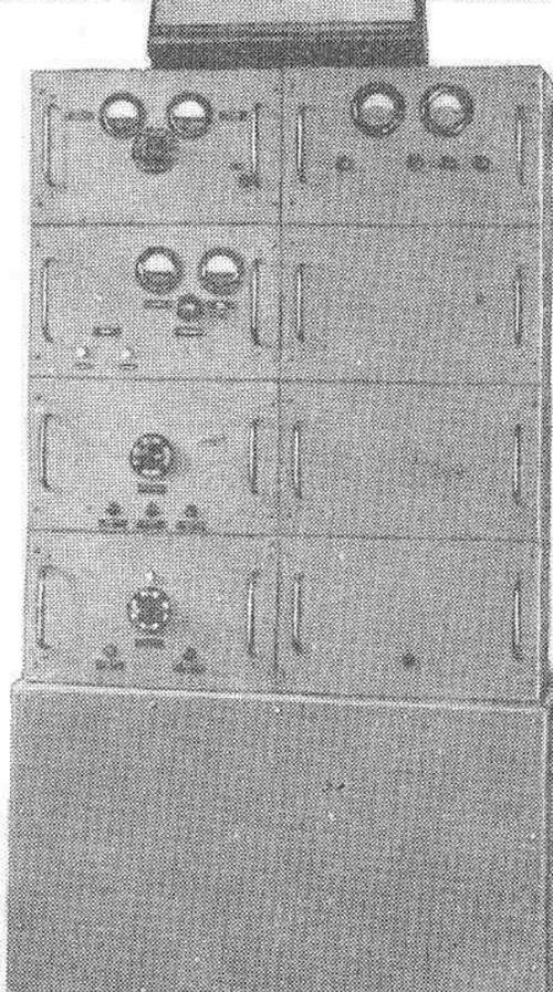
Oben: Aufrichten der Sendeantenne des UKW-Senders auf dem Funkhaus in Hannover. Unten: Der von Telefunken erbaute frequenzmodulierte UKW-Sender Hannover. Betriebsfrequenz 88,9 MHz, Sendeleistung 100 W
