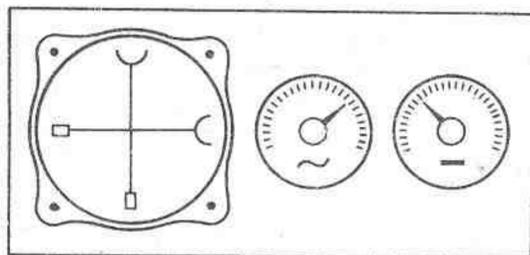
vielseitiges Meßinstrument für die Bastlerwerkstatt herstellen. Das Gerät besitzt zwei Meßwerke, von denen das mit dem senkrecht stehenden Zeiger  $25 \mu A$ , das mit dem waagerechten Zeiger  $50 \mu A$  Vollausschlag hat. Die eingebauten Nebenwiderstände sind zu entfernen. Das  $25 \mu A$ -Werk wird für Wechsel-, das mit  $50 \mu A$  für Gleichspannungsmessungen verwendet (Abb. 1).
