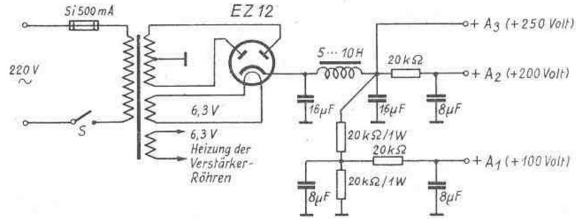
Abb. 2. Netzgerät zum Mikrofonverstärker
